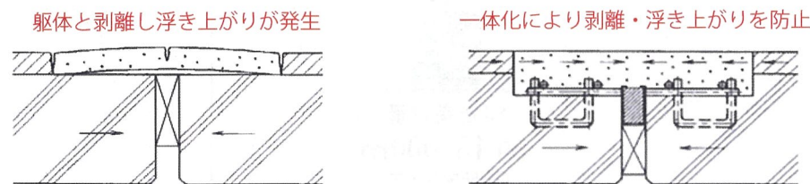
図Ⅱ.温度変化によって伸縮部が収縮（圧縮力が発生）した場合
