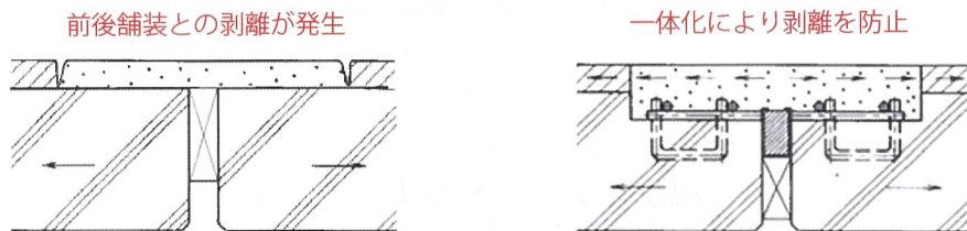
図Ⅱ.温度変化によって伸縮部が収縮（圧縮力が発生）した場合
