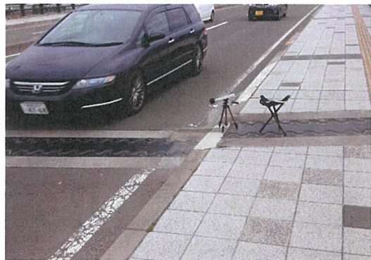
騒音値測定状況 (②ゴムジョイント)
