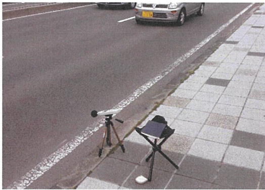
騒音測定状況 (①通常時)
