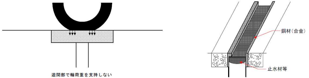
図-2.2.2.1 突合せ型鋼製伸縮装置の概要図
